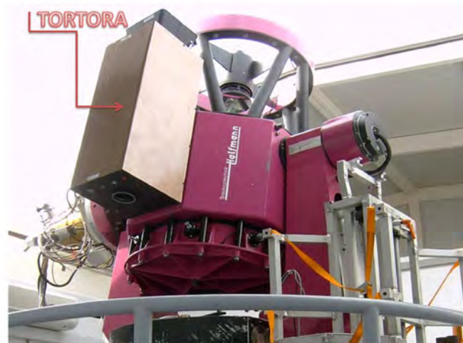
Il telescopio a grande campo TORTORA installato sulla montatura del telescopio robotico REM, ESO-La Silla, Cile.
