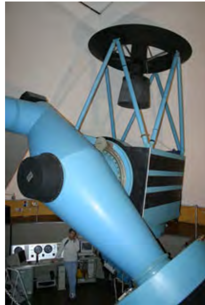
Il telescopio "G.D. Cassini", dell'Osservatorio astronomico INAF di Bologna, presso la stazione astronomica di Loiano, ha un diametro di 152cm ed è stato inaugurato nel 1976.
